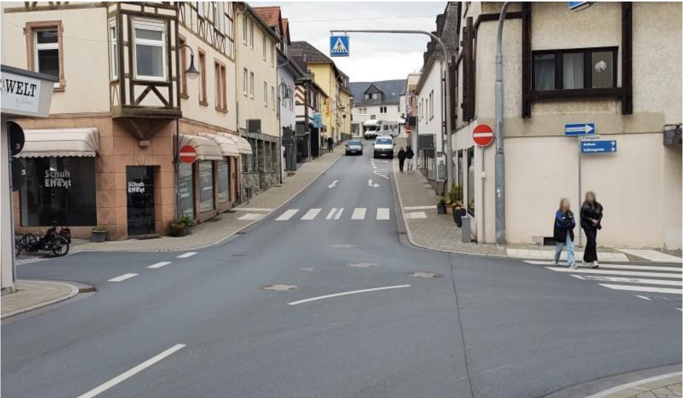
Bild 06: Zwei Fahrspuren, keine gegenläufige Radspur - nicht freigegebene Einbahnstraße
